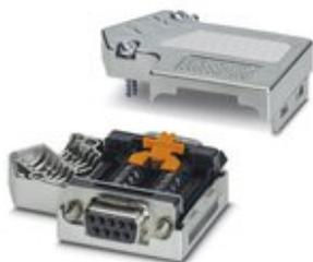
D-SUB-Stecker, 9-polige Buchse, Kabelzuführung unter 35°, Bussystem: CAN, CANopen®, SafetyBus-P bis 1 MBit/s, mit PG D-SUB-Buchse zum Anschluss eines Programmiergeräts, Abschlusswiderstand ü. Schiebeshalter zuschaltbar, Pinbelegung: 2, 3, 7, 9; Schraubklemmen
