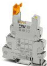
14 mm PLC-Grundklemme ohne Relaisbestückung, zur Montage auf Tragschiene NS 35/7,5, Schraubanschluss, 2 Wechsler, Eingangsspannung 230 V AC/DC
