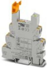
14 mm PLC-Grundklemme ohne Relaisbestückung, zur Montage auf Tragschiene NS 35/7,5, Push-in-Anschluss, 2 Wechsler, Eingangsspannung 24 V AC/DC
