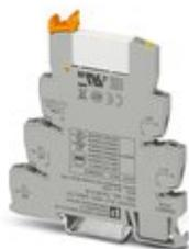
PLC-INTERFACE, bestehend aus Grundklemme PLC-BSC.../21 mit Schraubanschluss und steckbarem Miniaturrelais mit Leistungskontakt, zur Montage auf Tragschiene NS 35/7,5, 1 Wechsler, Eingangsspannung 24 V DC
