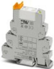
PLC-INTERFACE, bestehend aus Grundklemme PLC-BSC.../21 mit Schraubanschluss und steckbarem Miniaturrelais mit Leistungskontakt, zur Montage auf Tragschiene NS 35/7,5, 2 Wechsler, Eingangsspannung 24 V AC/DC
