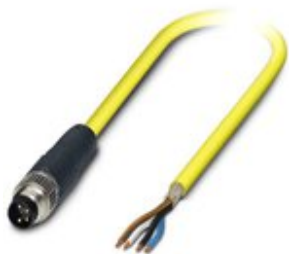
Sensor-/Aktor-Kabel, 4-polig, PVC, gelb, geschirmt, Stecker gerade M8, auf freies Leitungsende, Kabellänge: 5 m
