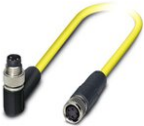
Sensor-/Aktor-Kabel, 4-polig, PVC, gelb, geschirmt, Stecker gewinkelt M8, auf Buchse gerade M8, Kabellänge: 0,5 m
