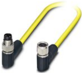
Sensor-/Aktor-Kabel, 3-polig, PVC, gelb, geschirmt, Stecker gewinkelt M8, auf Buchse gewinkelt M8, Kabellänge: 1,5 m
