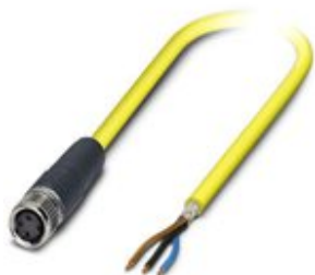
Sensor-/Aktor-Kabel, 3-polig, PVC, gelb, geschirmt, freies Leitungsende, auf Buchse gerade M8, Kabellänge: 2 m
