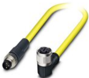
Sensor-/Aktor-Kabel, 3-polig, PVC, gelb, Stecker gerade M8, auf Buchse gewinkelt M12, Kodierung: A, Kabellänge: 1,5 m
