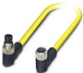
Sensor-/Aktor-Kabel, 3-polig, PVC, gelb, Stecker gewinkelt M8, auf Buchse gewinkelt M8, Kabellänge: 1,5 m
