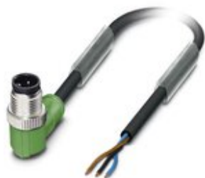
Sensor-/Aktor-Kabel, 3-polig, PVC, schwarz RAL 9005, Stecker gewinkelt M12, Kodierung: A, auf freies Leitungsende, Kabellänge: 10 m
