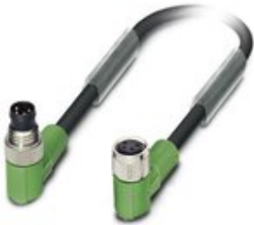
Sensor-/Aktor-Kabel, 4-polig, PVC, schwarz RAL 9005, Stecker gewinkelt M8, auf Buchse gewinkelt M8, Kabellänge: 0,3 m
