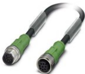
Sensor-/Aktor-Kabel, 8-polig, PVC, schwarz RAL 9005, Stecker gerade M12, Kodierung: A, auf Buchse gerade M12, Kodierung: A, Kabellänge: 0,3 m
