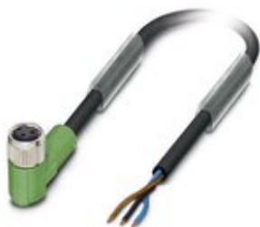
Sensor-/Aktor-Kabel, 3-polig, PVC, schwarz RAL 9005, freies Leitungsende, auf Buchse gewinkelt M8, Kabellänge: 1,5 m
