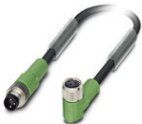
Sensor-/Aktor-Kabel, 3-polig, PVC, schwarz RAL 9005, Stecker gerade M8, auf Buchse gewinkelt M8, Kabellänge: 3 m
