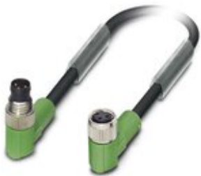
Sensor-/Aktor-Kabel, 3-polig, PVC, schwarz RAL 9005, Stecker gewinkelt M8, auf Buchse gewinkelt M8, Kabellänge: 1,5 m
