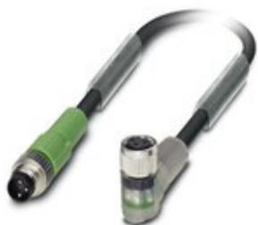
Sensor-/Aktor-Kabel, 3-polig, PVC, schwarz RAL 9005, Stecker gerade M8, auf Buchse gewinkelt M8, mit 2 LEDs, Kabellänge: 0,3 m
