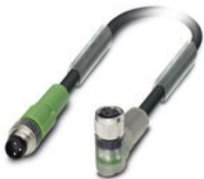
Sensor-/Aktor-Kabel, 3-polig, PVC, schwarz RAL 9005, Stecker gerade M8, auf Buchse gewinkelt M8, mit 2 LEDs, Kabellänge: 3 m
