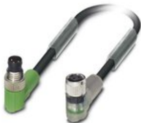
Sensor-/Aktor-Kabel, 3-polig, PVC, schwarz RAL 9005, Stecker gewinkelt M8, auf Buchse gewinkelt M8, mit 2 LEDs, Kabellänge: 3 m
