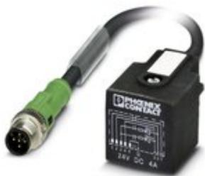
Sensor-/Aktor-Kabel, 5-polig, PUR halogenfrei, schwarzgrau RAL 7021, Stecker gerade M12 SPEEDCON, Kodierung: A, auf Ventilstecker AD (Druckschalter), mit 2 LEDs, Kabellänge: 0,6 m
