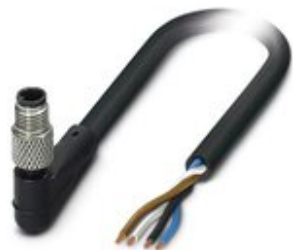
Sensor-/Aktor-Kabel, 4-polig, PUR, schwarz RAL 9005, Stecker gewinkelt M5, Kodierung: A, auf freies Leitungsende, Kabellänge: 1,5 m
