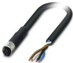
Sensor-/Aktor-Kabel, 4-polig, PUR, schwarz RAL 9005, freies Leitungsende, auf Buchse gerade M5, Kodierung: A, Kabellänge: 10 m
