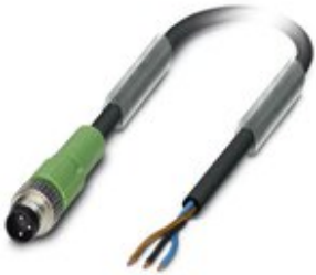
Sensor-/Aktor-Kabel, 3-polig, PUR halogenfrei, schwarzgrau RAL 7021, Stecker gerade M8, auf freies Leitungsende, Kabellänge: 1,5 m
