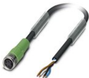
Sensor-/Aktor-Kabel, 4-polig, PUR halogenfrei, schwarzgrau RAL 7021, freies Leitungsende, auf Buchse gerade M8, Kabellänge: 3 m
