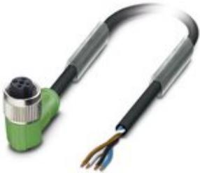
Sensor-/Aktor-Kabel, 4-polig, PVC, schwarz RAL 9005, freies Leitungsende, auf Buchse gewinkelt M12, Kodierung: A, Kabellänge: 5 m
