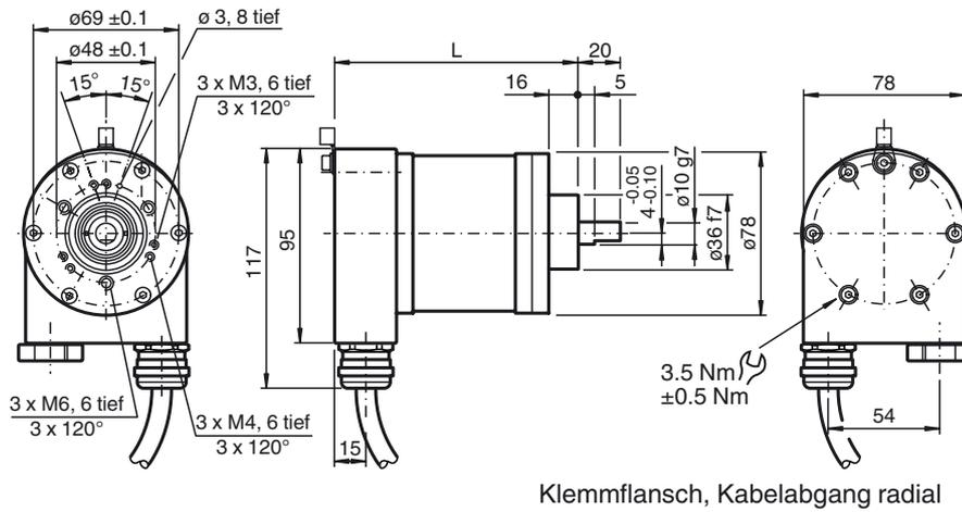
Klemmflansch, Kabelabgang radial
