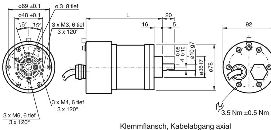
Klemmflansch, Kabelabgang axial
