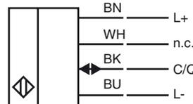
**Elektrischer Anschluss Empfänger**
