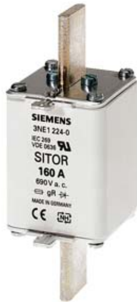
SITOR FUSE-LINK UTILIZ. CATEGORY GS, DIN 43620 160A , AC 690 V ,(SIZE 1)
