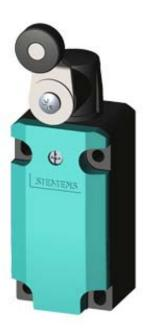
SIRIUS POSITION SWITCH METAL HOUSING 40MM TO EN50041 DEVICE CONNECTION 1X (M20X1,5) 1NO/ 1NC SNAP-ACTION CONTACTS ROTARY ACTUATOR RIGHT/LEFT ADJUSTABLE, METAL LEVER 27MM LONG AND PLASTIC ROLLER 19MM
