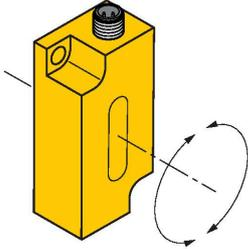
Einstellung des Messbereiches mittels Teachadapter TX1-Q20L60
