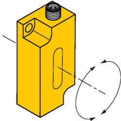
Einstellung des Messbereiches mittels Teachadapter TX1-Q20L60
