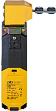
Schutztürsystem mit Zuhaltung, mit Standardbetätiger, Verriegelungsprinzip Federkraft, Kontakte 2 n/o, 2 n/c, Versorgungsspannung 24 V AC/DC.
