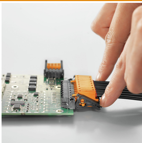
Schonendes Entriegeln Geringe mech. Beanspruchung
