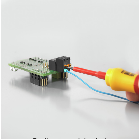
Bedienungssicherheit Durch PUSH IN-Anschluss-technik
